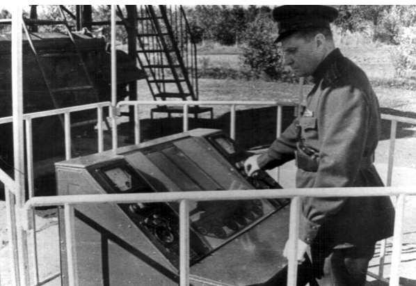
В Академии бронетанковых войск. Освоение пульта по управлению вывода (выхода) экипажа из затопленного танка (1960 е )
